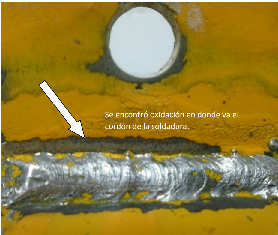
Imagen 10. Cordón de soldadura con oxido.
