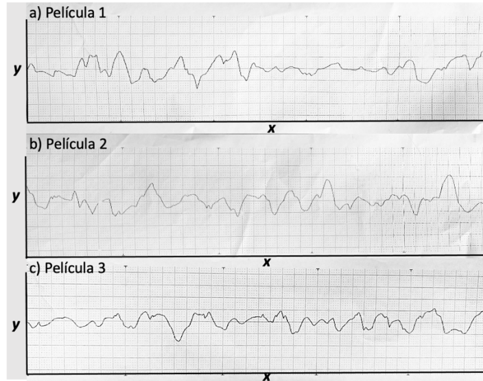
Figura 27. Gráficas obtenidos de la máquina verificadora de rugosidad superficial Mitutoyo SURFTEST SJ-310 en donde se observan las crestas y valles en el eje de las x y y que determinan la cantidad de rugosidad de las 3 películas
