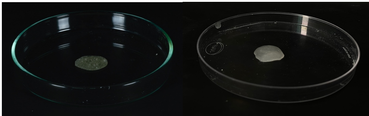
Figura 24. Película antes de sumergirse en saliva artificial y a los 60 minutos después hincharse.
