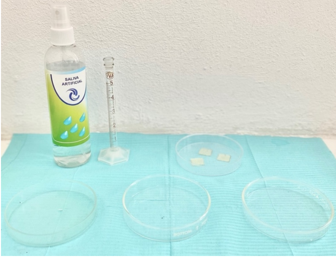
Figura 11. Saliva artificial, películas cortadas e instrumentos para elaboración de la prueba de hinchamiento. Fuente propia.
