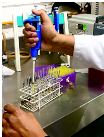
Figura 17. Realización de la prueba de liberación mediante el ensayo de Bradford.
