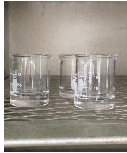
Figura 12. Películas inmersas en 5ml de saliva artificial a 37°C en la estufa de secado. Fuente propia.
