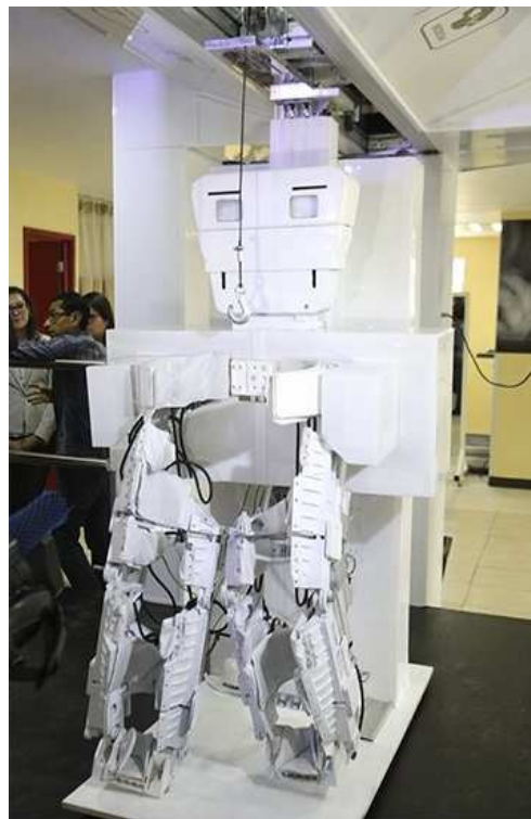
Figura 1.14: Sistema de rehabilitación por IPN.
