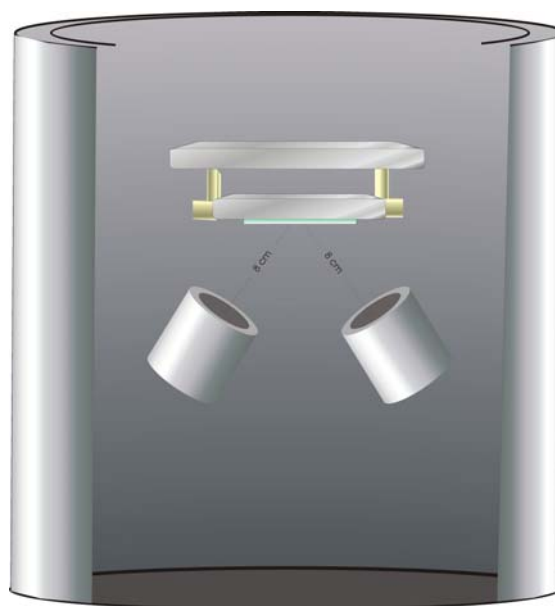
Figura 9.1: Arreglo del sistema de erosión catódica utilizado para el crecimiento de las películas.
