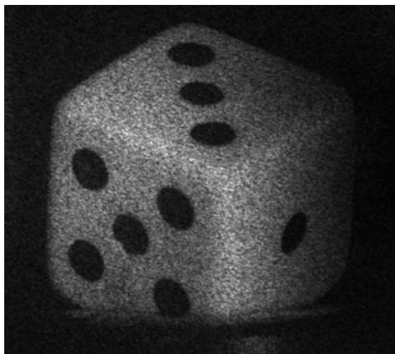
Figura 3.10: Orden uno de difracción recortado de la reconstrucción. Con filtro pasabajas.
