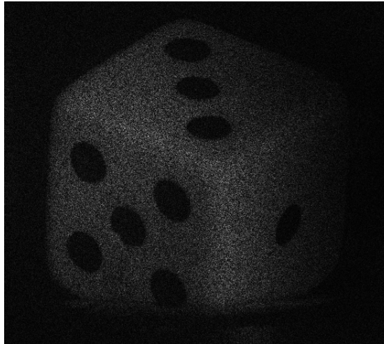
Figura 3.9: Orden uno de difracción recortado de la reconstrucción.
