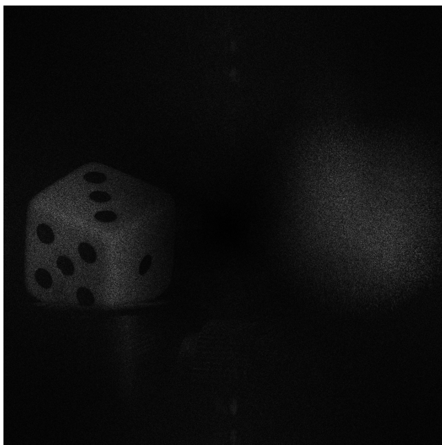
Figura 3.8: Holograma completo filtrando el orden cero. Sin ajuste de contraste.
