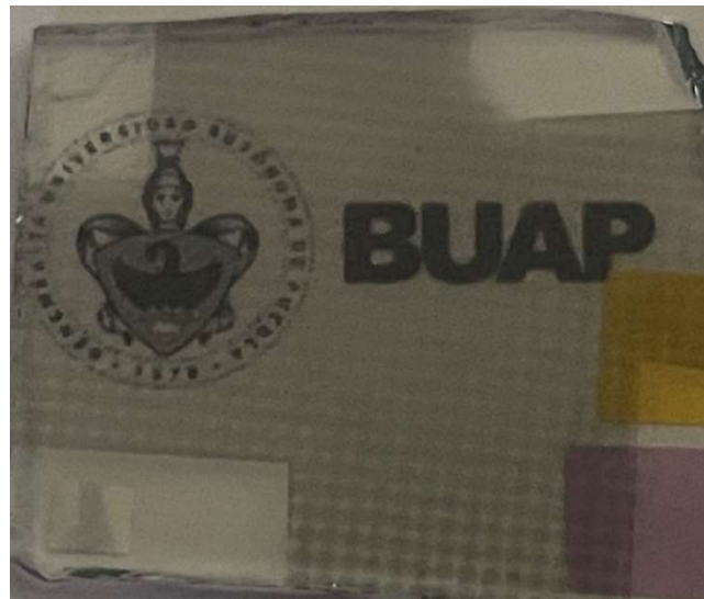
Figura 4.7: Dispositivos Corning/ITO/MnPc/ Al_2O_3 /Au ó Ag.
