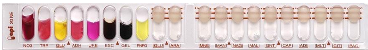
Figura 5. Galería multipuebas API20NE transcurridas 24 horas de incubación a 37°C
