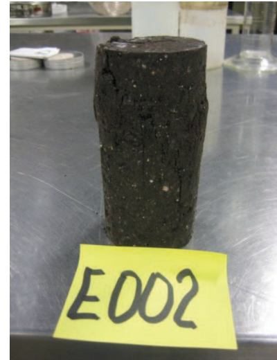
Figura 3.28. (a) Ejecución de la prueba (b) Espécimen fallado al final de la prueba.
