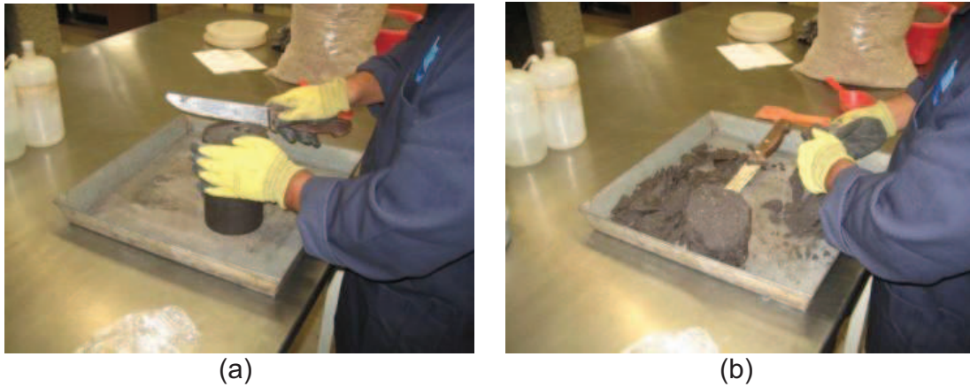
Figura 3.13. (a) Eliminación del material exterior, (b) Obtención del material para determinar el contenido de agua.
