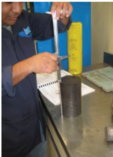
Figura 3.12. (a) Extracción del espécimen, (b) Determinación del diámetro, (c) Determinación de la altura, y (d) Determinación del peso de la muestra.
