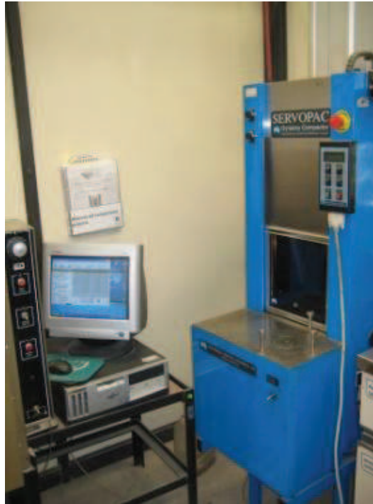
Figura 3.2. Equipo Compactador Giratorio SERVOPAC.
