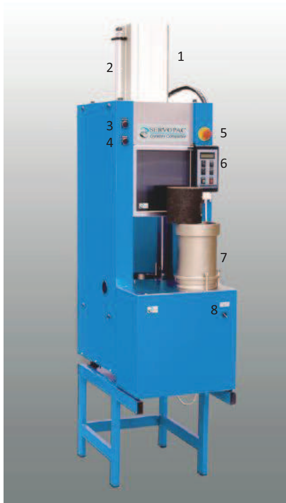
Figura 3.4. Componentes del Compactador Giratorio SERVOPAC (www.gcts.com).
