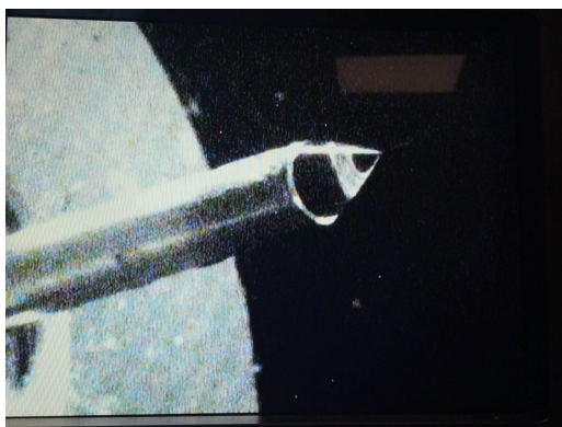
Figura 2.1: Formación del cono de Taylor durante el electroroció vista con la cámara del equipo BIOINICIA FLUIDNATEK LE-50.
