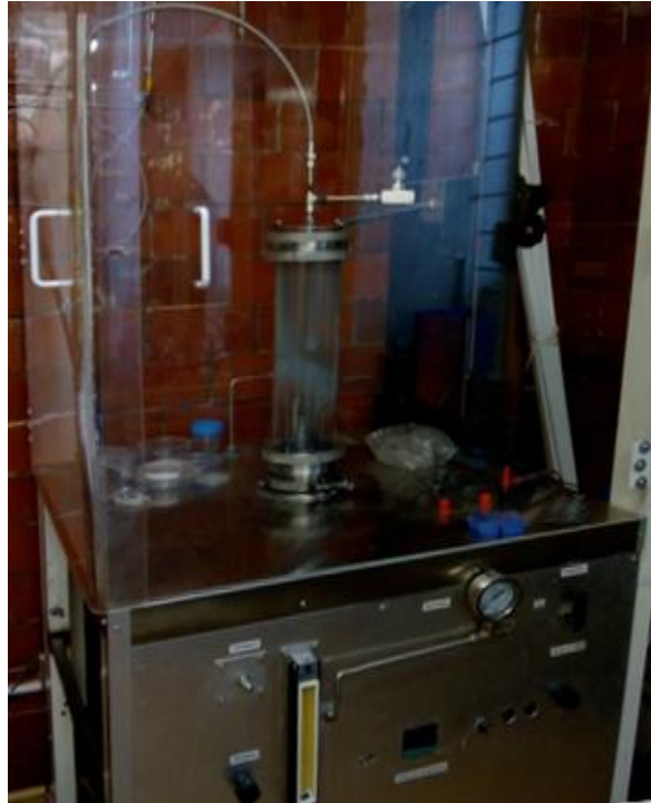
Figura 2.3 Reactor HFCVD vertical. [Fotografía tomada en laboratorio del CIDS-BUAP].
