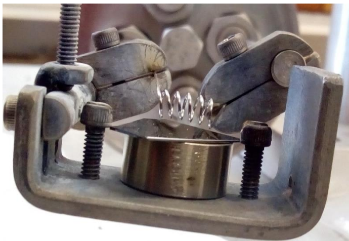
○ Figura C.3 Fotografía del montaje para depósito de C.
