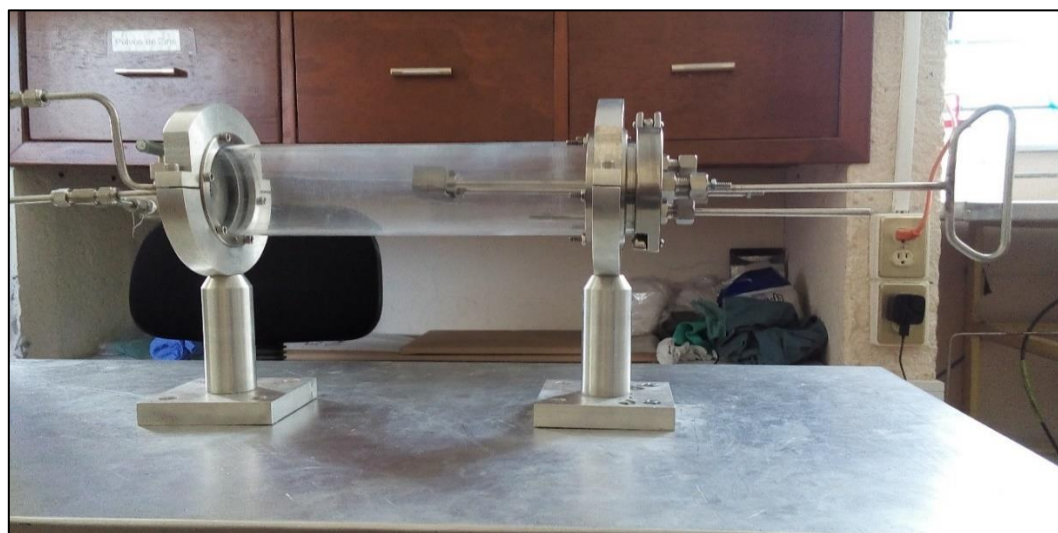
Figura 3.3 Cámara de reacción HFCVD ensamblada físicamente en los laboratorios del CIDS-BUAP para el depósito de SiOC [Fotografía tomada en CIDS-BUAP].
