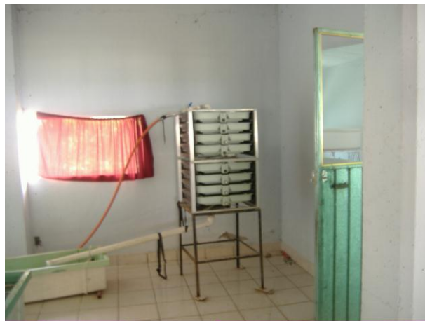
Foto 21. Charola metálica para recibir huevesillos (sala de incubación)
