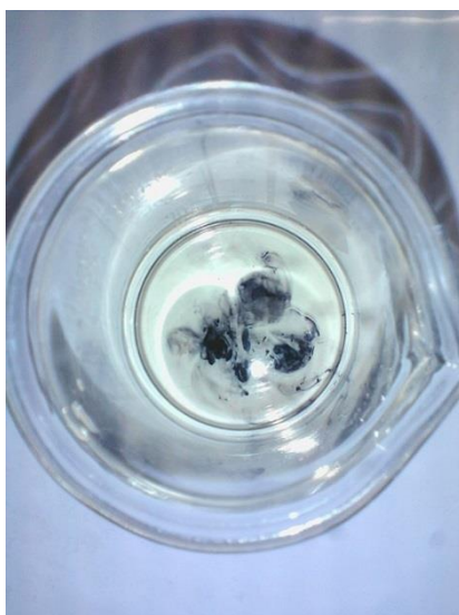
Figura 4.2: Reacción del extracto tánico con el Cloruro Férrico
