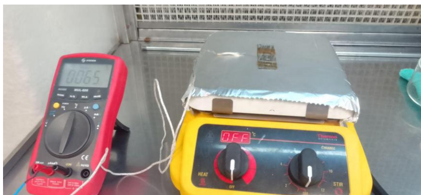
Figura 2.8 Arreglo experimental para el depósito de películas de \text{Sb}_2\text{S}_3 en acero inoxidable 430.
