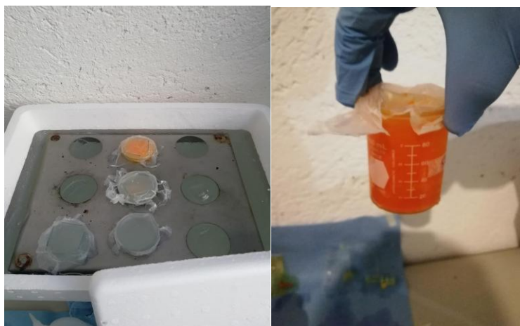
Figura 2.5 Solución de baño químico después de la formación de Sb_2S_3 para su depósito en acero inoxidable 430.
