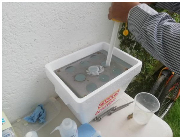
Figura 2.3 Imagen del arreglo experimental para el depósito por CBD de \text{Sb}_2\text{S}_3 .
