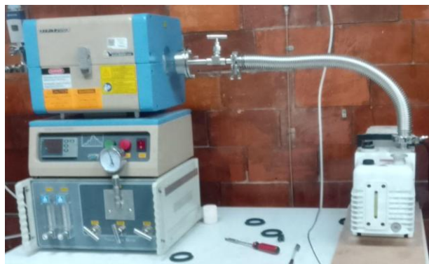
Figura 2.9 Arreglo experimental para el tratamiento térmico a presión de 7.8 mTorr de películas de \text{Sb}_2\text{S}_3 depositado en acero inoxidable 430.
