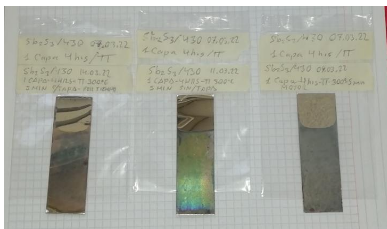
Figura 2.2. Películas de Sb 2 S 3 tratadas térmicamente a 300 °C por 5 minutos.
