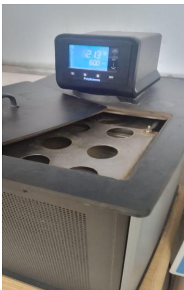
Figura 2.11 Recirculador automático para el depósito por baño químico de CdS.
