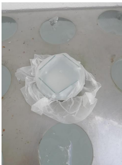
Figura 2.4 Solución de baño químico a temperatura de 2 °C para el depósito de la película de \text{Sb}_2\text{S}_3 en acero inoxidable 430.
