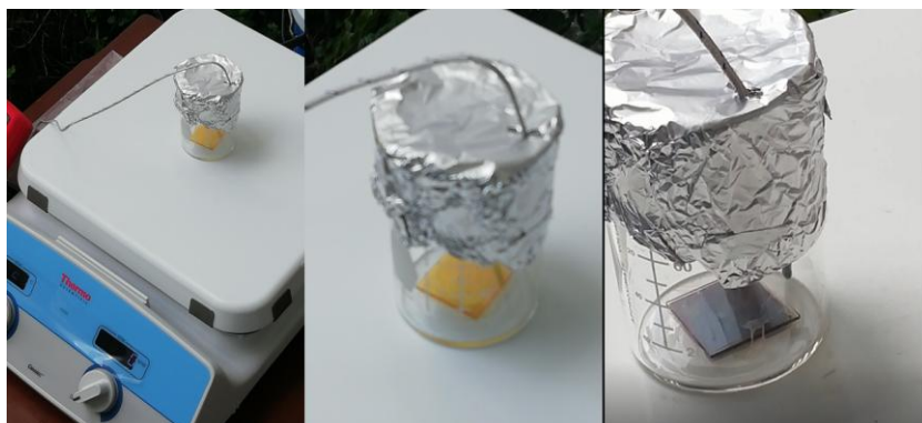
Figura 2.7 Arreglo experimental para el tratamiento térmico del \text{Sb}_2\text{S}_3 depositado en vidrio.
