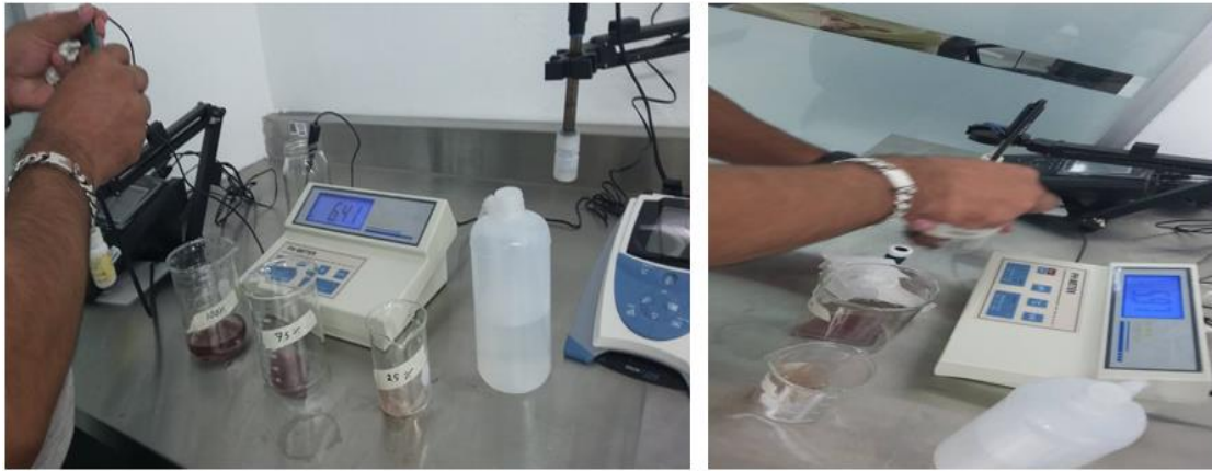
Figura 15. Mediciones de pH de los tres colorantes a diferentes concentraciones.
