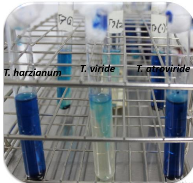
Figura 45. T. atroviride , T. viride y T. harzianum en una concentración al 75% de azul índigo.
