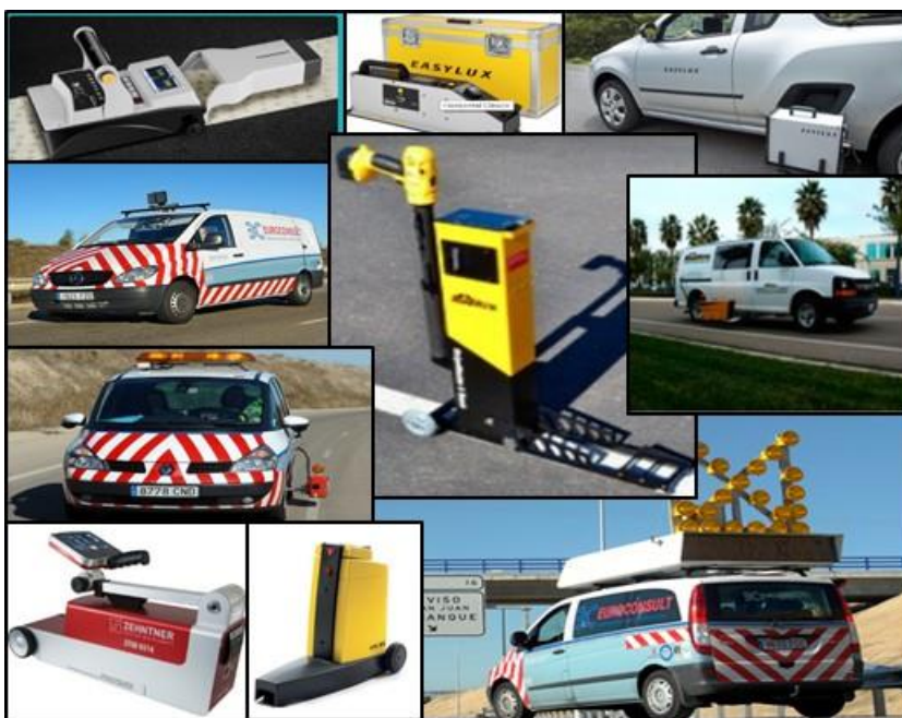
Figura 32. Equipo para medir la retrorreflexión horizontal Fuente: Road Vista. (2018). StripeMaster Touch Series Retroreflectometers . Recuperado el 16 de 04 de 2018, de Road Vista: http://www.roadvista.com/stripemaster-2-touch-retroreflectometer
