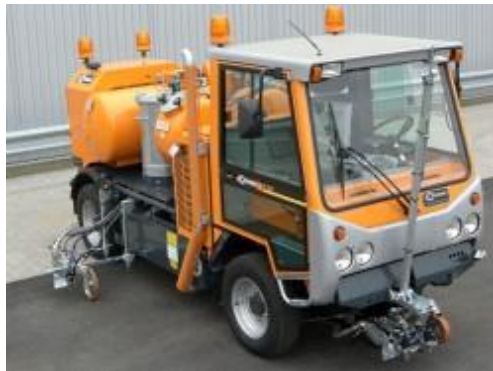
Figura 16. Equipo especializado para aplicar señalamiento horizontal Fuente: Tecmapro. (2015). Camión demarcación vial Hofmann H35. Recuperado el 30 de 03 de 2018, de Tecmapro: https://www.tecmapro.com/maquinas-pintabandas-hofmann-roadmarking/camion-demarcacion-vial-hofmann-h35.html#.Wz98hNizbIU
