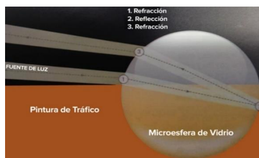
Figura 17. Efecto de retroreflexión en la microesfera Fuente: Signo Vial. (10 de febrero de 2016). Marcando el camino: Pinturas de tráfico y otras marcas viales . Recuperado el 02 de 04 de 2018, de Signo Vial: http://signovial.pe/blog/category/senalizacion-2/page/2/
