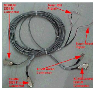
Fig. 4.14 cables de control
