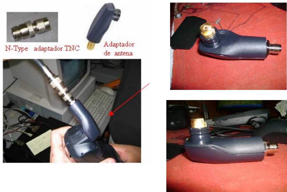
Fig. 1.6-C Adaptando la antena al adaptador TNC
