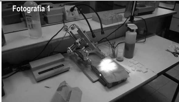
Equipo y materiales utilizados para la realización de la técnica de microinyección de fármacos activos dentro de las bursas ováricas.
