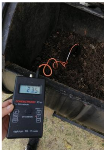
Figura 12. Toma de temperatura con el conductímetro.
