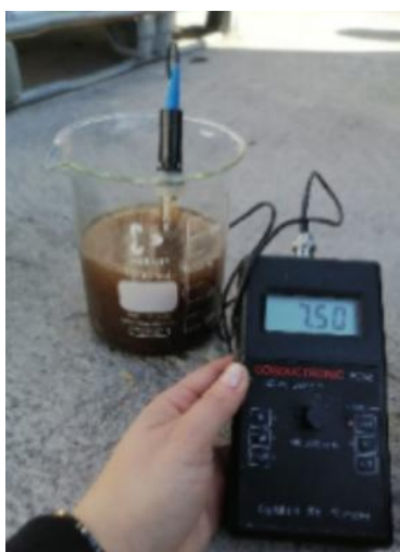
Figura 16. Medición de pH en solución acuosa.
