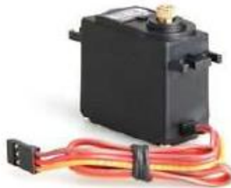
Figura 4.8 Servomotor de dirección del robot móvil HUMMER H2.
