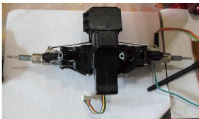
Figura 4.11 Potenciómetro utilizado como sensor de la dirección del robot móvil HUMMER H2.
