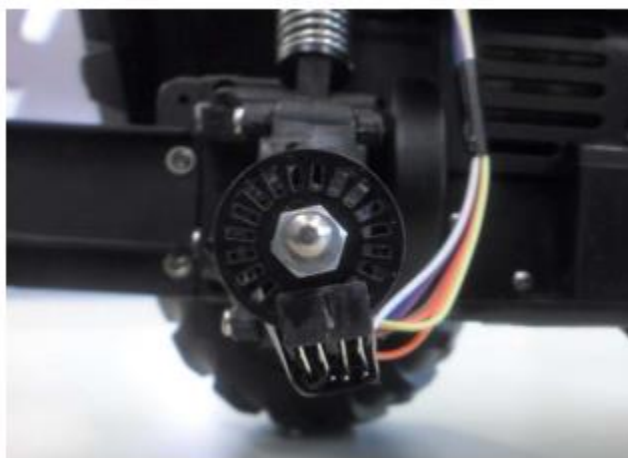
Figura 4.10 Encoder utilizado como sensor de posición del robot móvil HUMMER H2.
