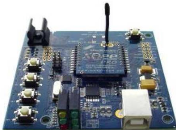
Figura 4.14 Tarjeta de interfaz USB (XBIB-U-DEV).
