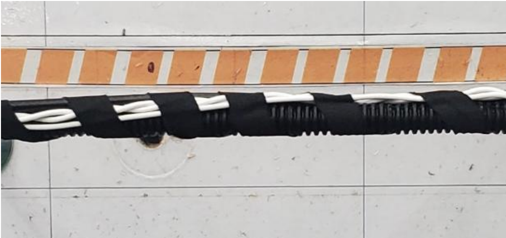
Ilustración 2. Encintado alternativo que se realiza en célula de producción TPD.
