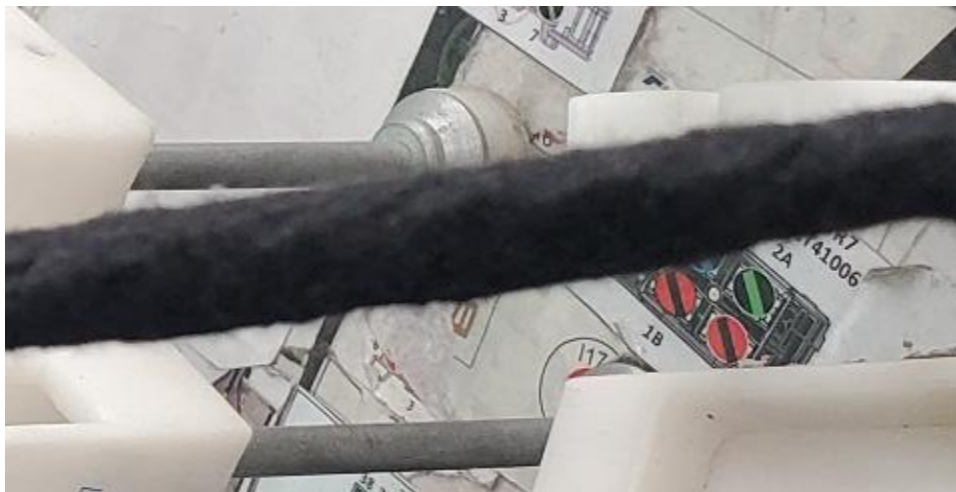
Ilustración 1. Encintado continuo que se realiza en célula de producción TPD.
