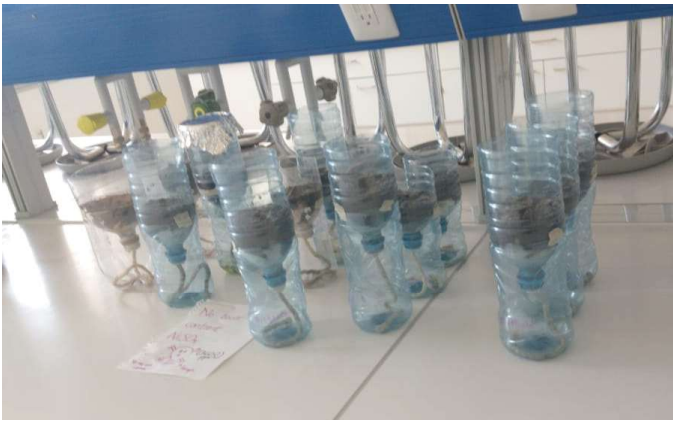
Figura 3. Jarras de Leonard realizadas con botellas PET de 1 L.
