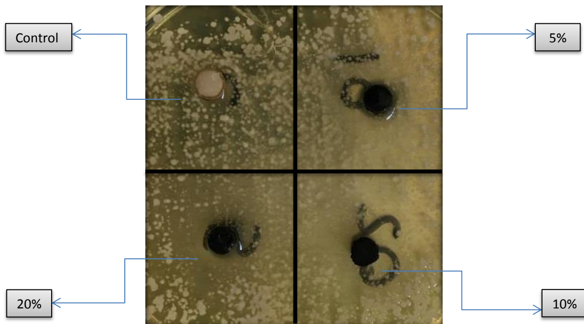
Fig. 15.1 Muestras de CIV a diferentes concentraciones de nanopartículas con Óxido de Grafeno.
