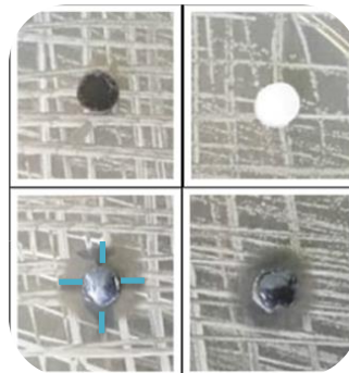
Figura 8. Medición de halos de inhibición
