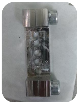
Figura 3. Elaboración de moldes. Diámetro de 6 mm, grosor de 1.8 mm.
