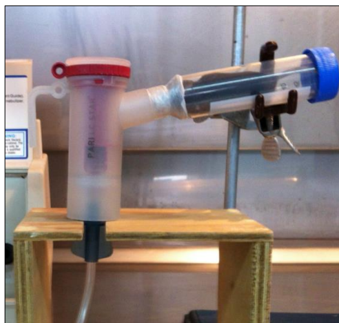
Figura 3. Administración de tratamientos en aerosol. El ratón se introdujo en un tubo falcón de 50 mL al cual se le cortó la punta; a través del orificio resultante, la nariz del ratón estuvo en contacto con el tratamiento inhalado.
