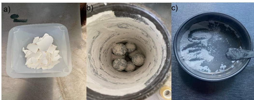
Figura III-1. a) Cascarones de huevo limpios, b) reducción del tamaño de partícula de \text{CaCO}_3 por medio del molino de bolas y c) tamizado con malla 325.
