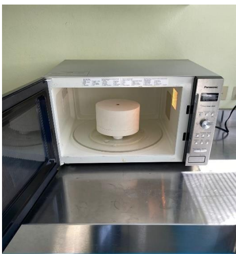
Figura II-2. Capsula de fibra cerámica con recubrimiento de carburo de silicio.
