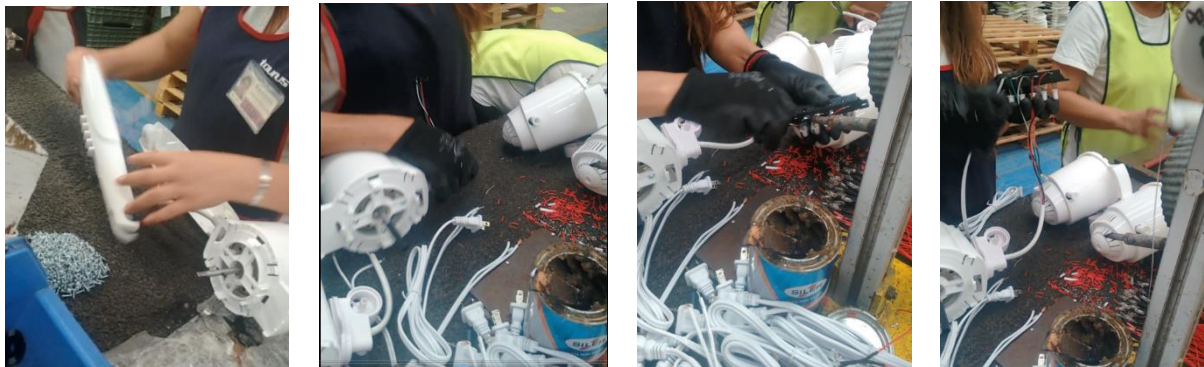
Imagen 39: Armado de ventiladores
