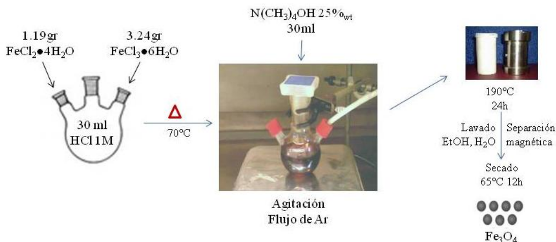
Figura 3.2 Esquema de síntesis de magnetita utilizando el método de co-precipitación asistido por tratamiento hidrotérmal (muestra C-1).
