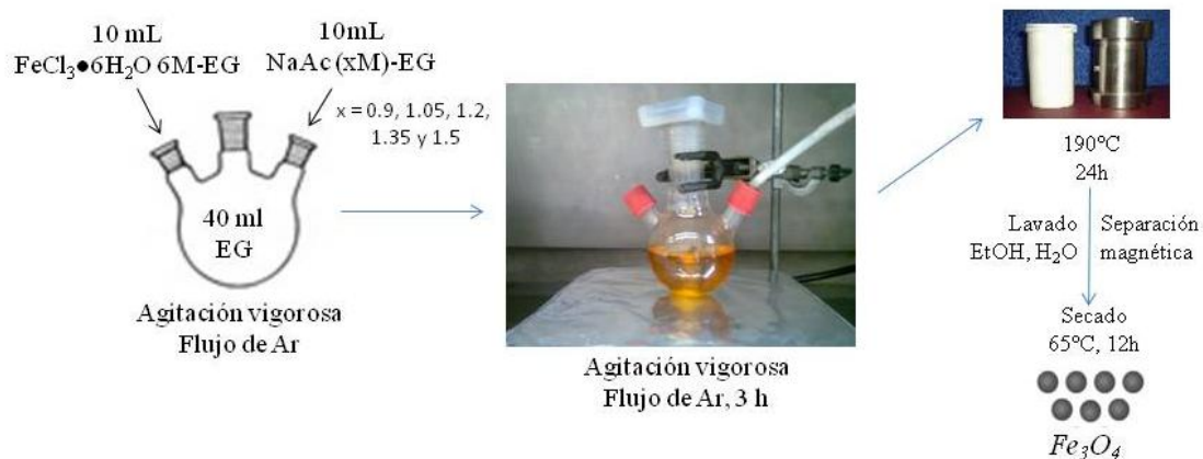
Figura 3.3 Esquema de síntesis de magnetita utilizando el método hidrotermal.
