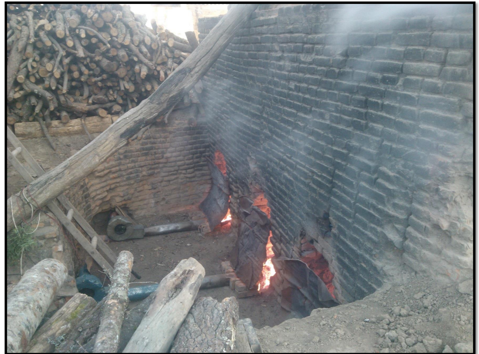
IMAGEN 4.2.10 QUEMA DE HORNO CON LEÑA. (COLECCIÓN PROPIA, 2015)
