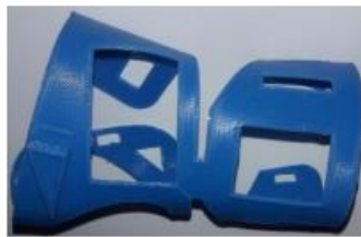
Figura 4 - Ortesis impresa en 3D posterior al termoformado.
