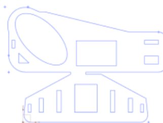
Figura 2 – Sketch del diseño final de la ortesis con modificaciones.
