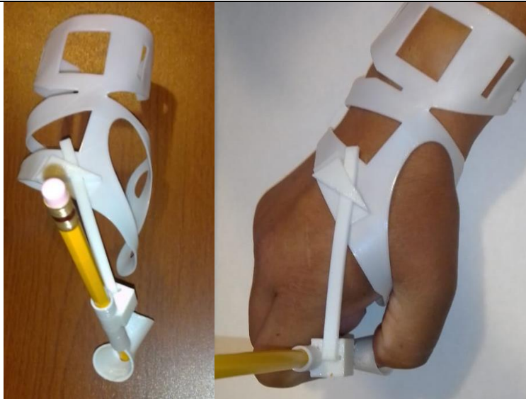
Figura 4.27. Prueba de evaluación del ajuste de la ortosis con el sujeto de prueba, donde la imagen verifica un mejor ajuste proporcional a las curvas del brazo y la mano.
