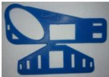
Figura 5. Ortesis impresa en 3D utilizando PLA como material de impresión.
