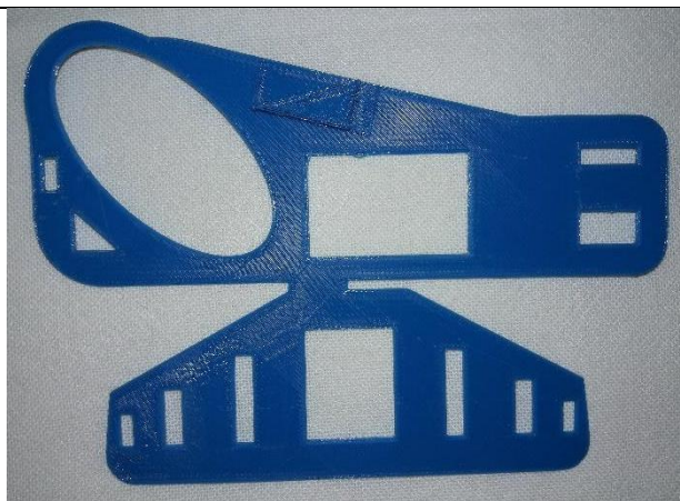
Figura 4.49. Ortesis impresa en 3D utilizando PLA como material de impresión.
