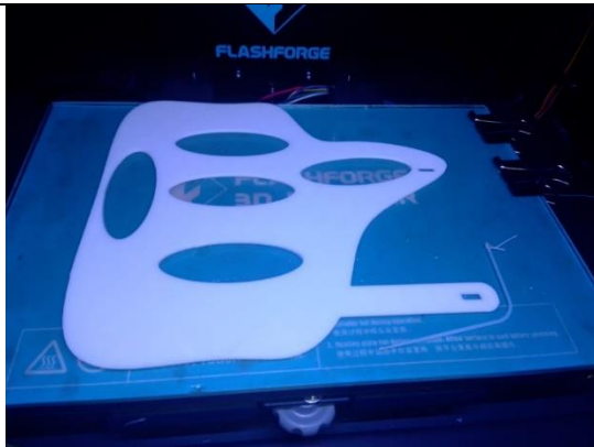
Figura 4.8. Primer momento del modelo perforado durante la impresión en 3D.
