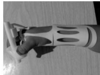
Figura 7. Uso de la ortesis para validación de su función. Elaboración propia.
