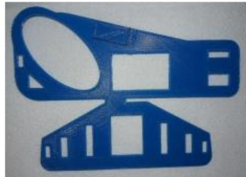
Fig. 7 Ortesis impresa en 3D utilizando PLA como material de impresión.
