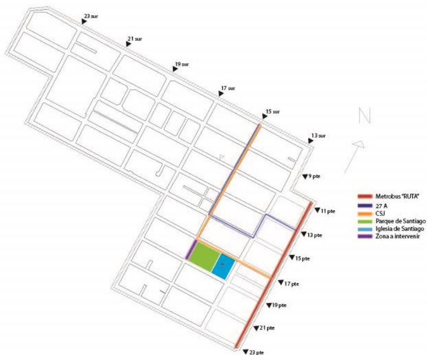
Figura 4.3.6.- Evaluar las posibles rutas alternas y contemplar la peatonalización de un segmento de la vialidad principal para alejar el ruido. Fuente: Elaboración propia.
