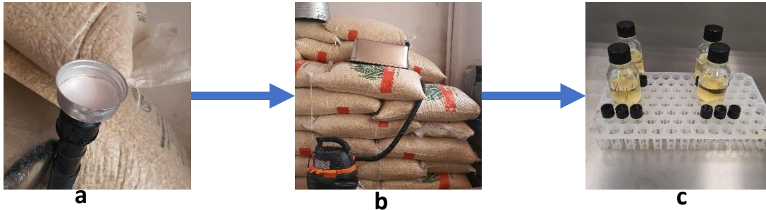
Figura 9. Análisis Microbiológico, muestreo ambiental. a) Tamiz; b) Aspirado; c) Diluciones. Laboratorio micología CU BUAP 2022
