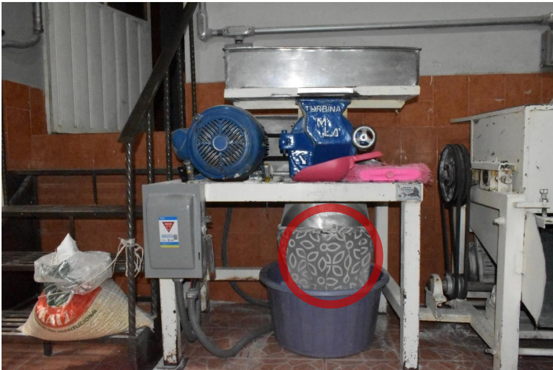
Figura 18. Molino de grano de maíz nixtamalizado; en rojo tela usada como tolva. San Tadeo Huiloapan Tlaxcala 2022
