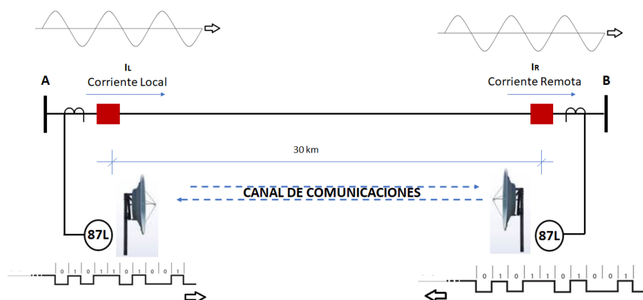
Figura 31 Esquema 87L con Canal de Comunicación Radio Enlace
