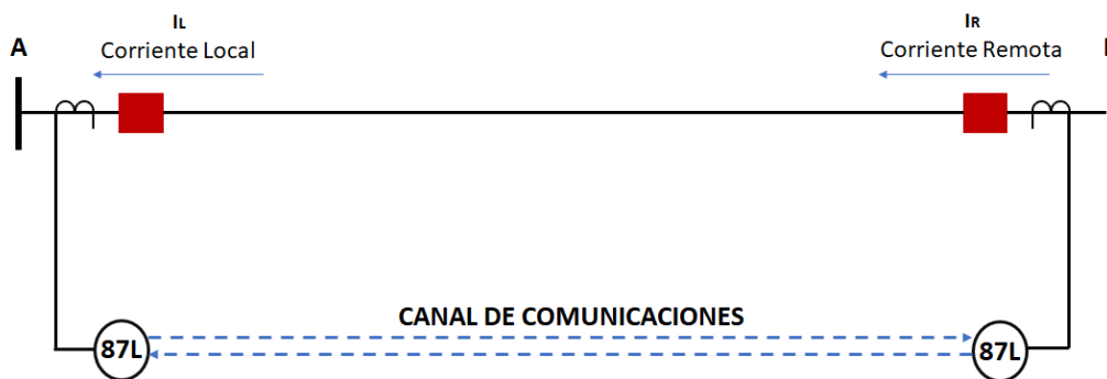
Figura 1 Esquema Diferencial de Línea
