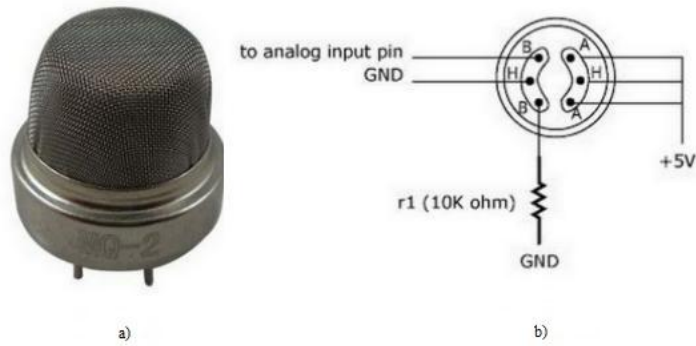
Figura 2.3. a) Sensor de Gas MQ-2, b) Diagrama de conexiones
