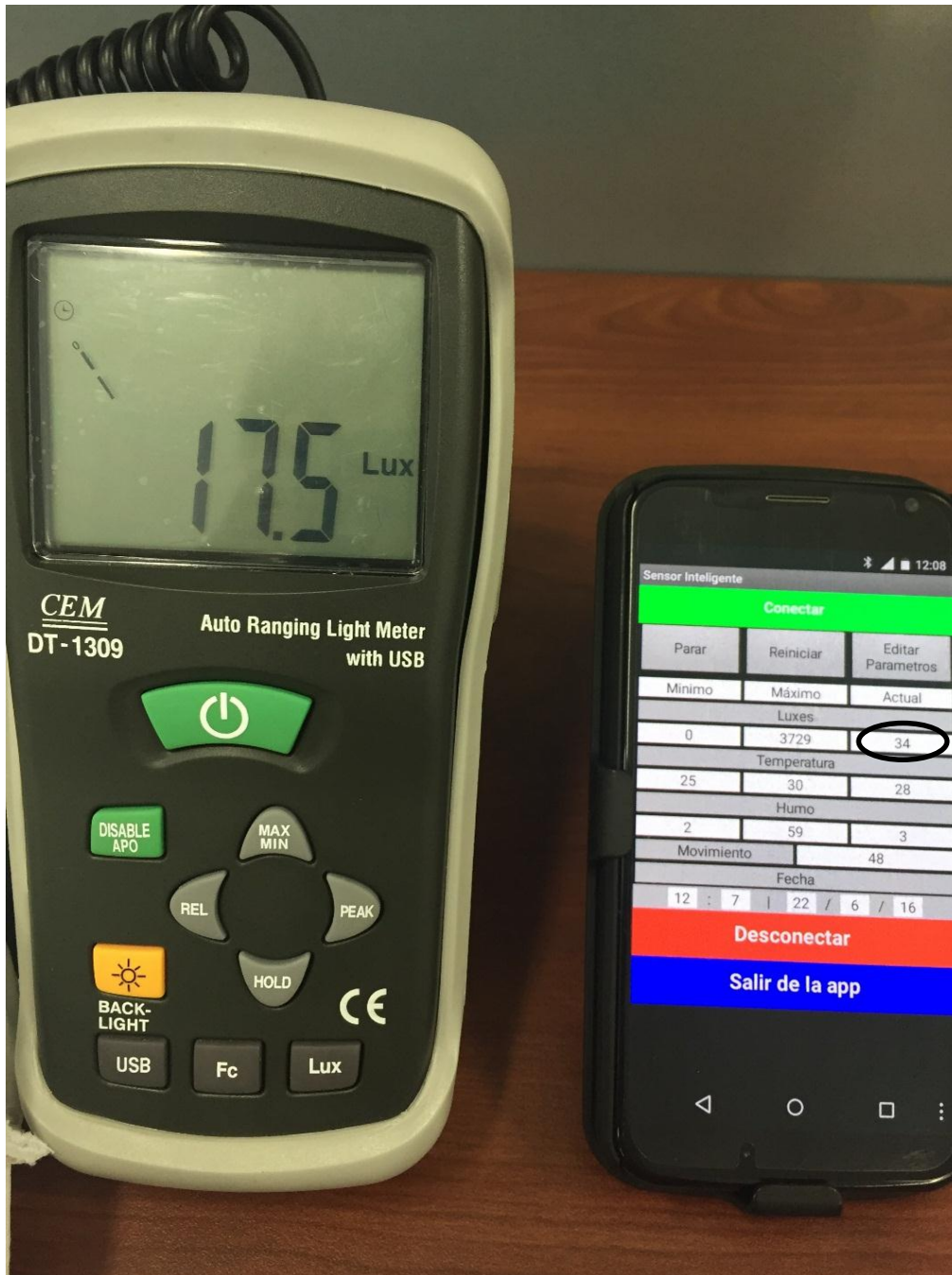
Figura 6.2. Monitorización de la iluminación con respecto a un luxómetro
