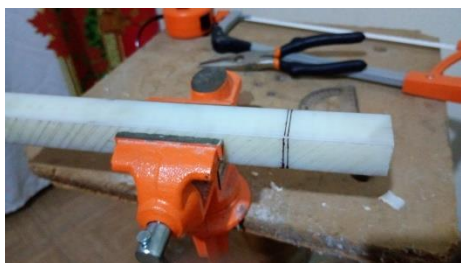
6Fig6. Trazo de corte para el largo de dimensiones de 55 mm
