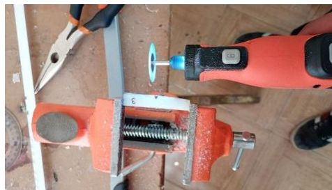
12Fig12. Corte de muesca con Dremel
