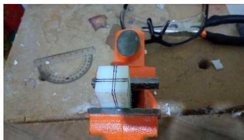
8Fig8. Trazo de corte para obtener segmentos de 1 cm x 1 cm x 5.5 cm
