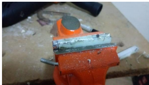
9Fig9. Trazo de corte para obtener probetas grosor de 4 mm
