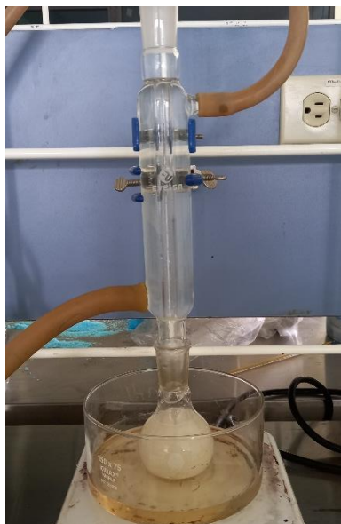
Figura 6. Equipo de destilación simple en el que se realizó la hidrólisis ácida de las fibras de algodón plisado.
