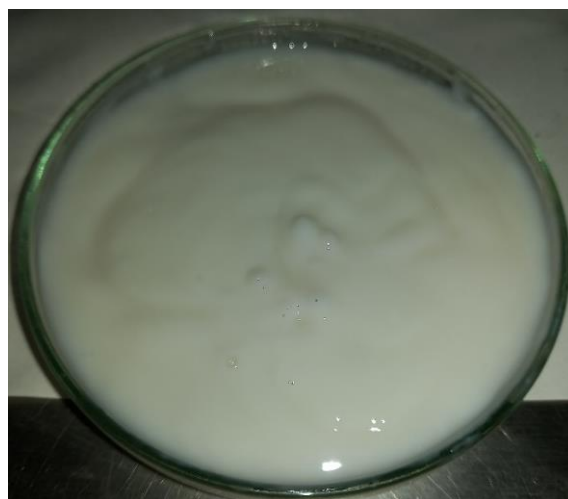
Figura 7. Apariencia del hidrolizado NCC 1 con H_2SO_4 de las fibras de algodón plisado, antes de ser dispersado en agua destilada.
