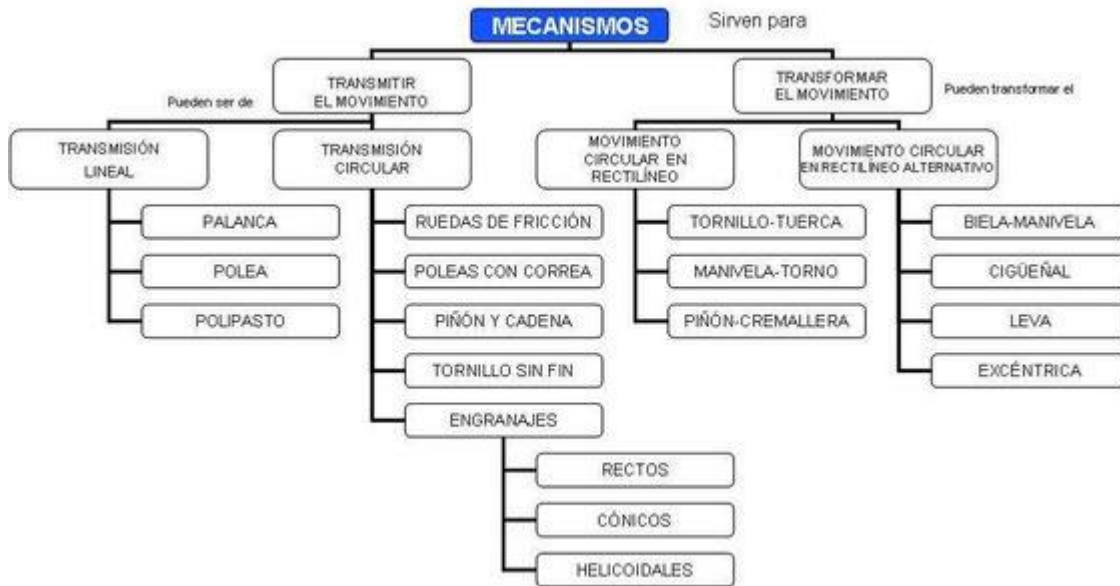
Ilustración 1. Tipos y componentes básicos de un mecanismo
