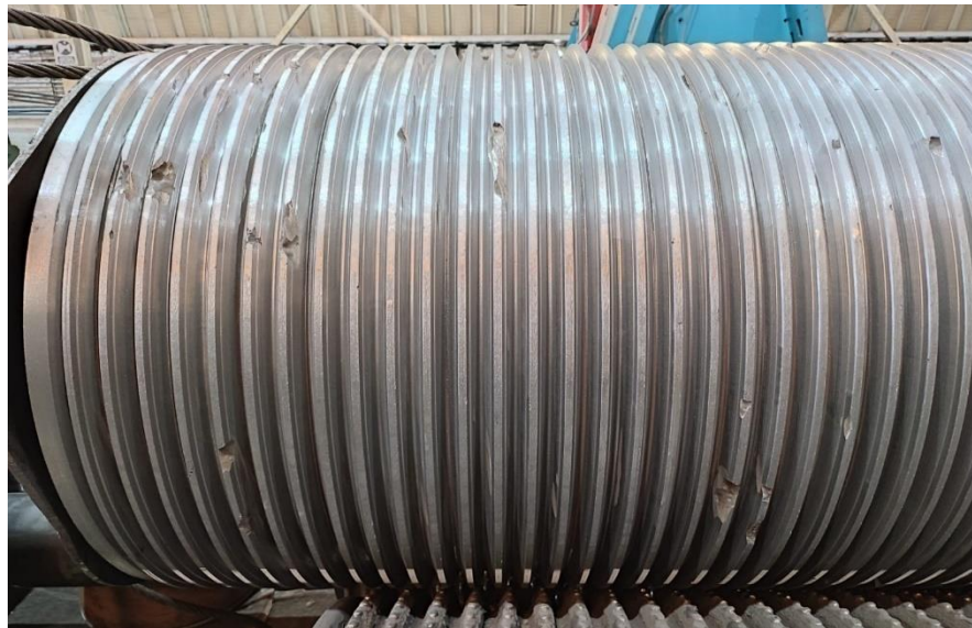
Imagen 4. Desperfecto provocado por un mal transporte
