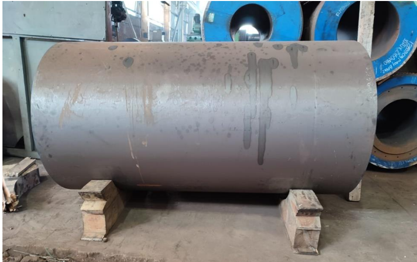
Imagen 1. Forma correcta de colocar una bobina horizontal
