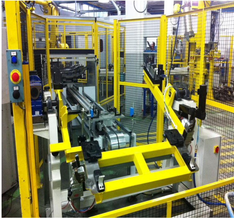
Ilustración 12. Volteador de piezas voluminosas
