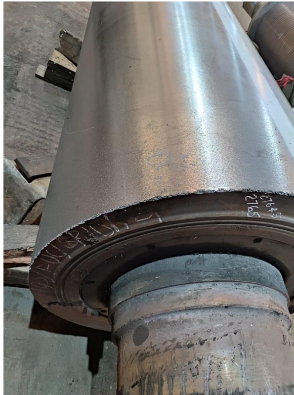
Imagen 3. Deterioros a causa de un mal almacenaje
