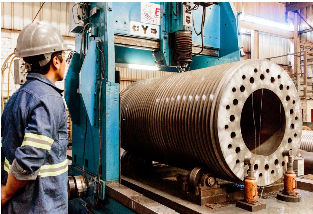
Imagen 12. Proceso de fabricación de las mazas para los ingenios azucareros
