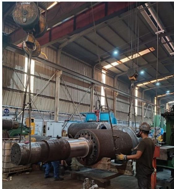
Imagen 11. Transporte de una maza utilizando dos grúas
