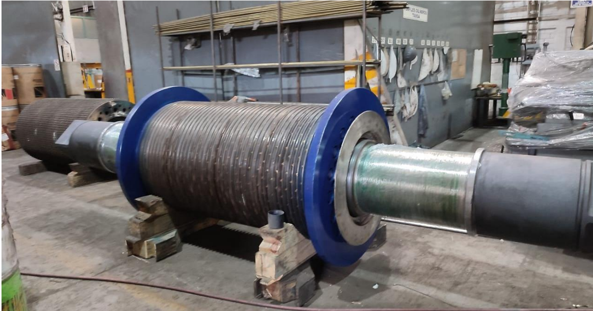
Imagen 7. Maza terminada para molinos azucareros que muestra posibles puntos de anclaje
