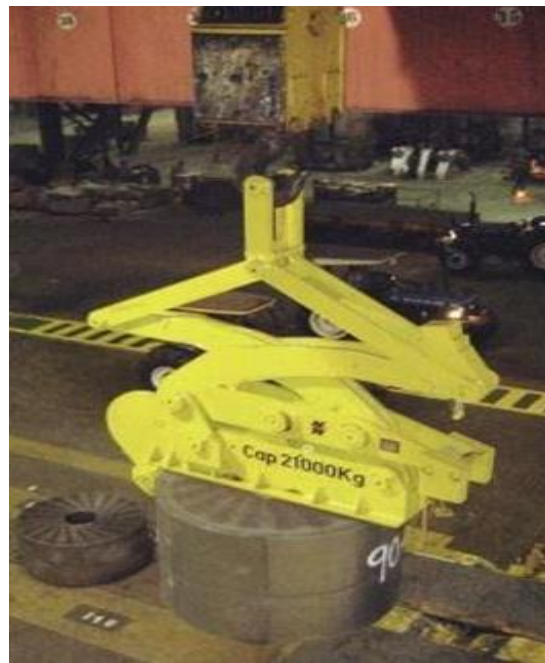
Ilustración 15. Pinza cargabobinas vertical del fabricante Sidor
