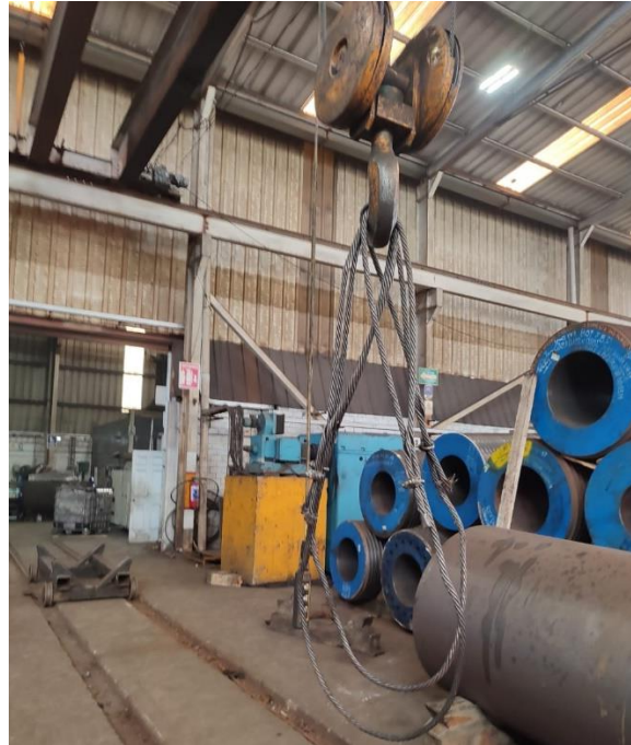
Imagen 6. Traslado de mazas con el apoyo de cables o estrobos
