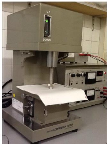
Figura 202. Izquierda: Unidad de medida del grosor en el equipo KES-FB del Laboratorio de parametría física textil. Instituto de Investigación Textil y Cooperación Industrial de Terrassa. Universitat Politècnica de Catalunya. Derecha: Expresión gráfica de los resultados del ensayo de Compresión (imagen obtenida de Galissa, E.C., Caracterización de tejidos. Principales ensayos físicos para evaluar la calidad de los tejidos textiles, página 196).
