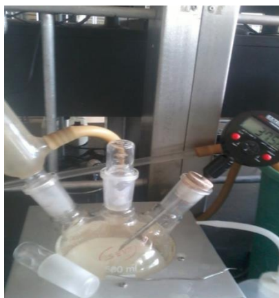
Imagen 19. Síntesis por sol-gel del nanomaterial de ZnO-40
