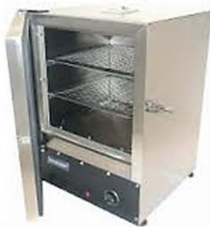
Imagen 23. Secado de los nanomateriales de ZnO-40 y Mite-Alve/ZnO-15-15-40
