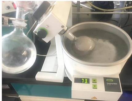
Imagen 22. Eliminación del solvente del nanomaterial Mite-Alve/ZnO-15-15-40
