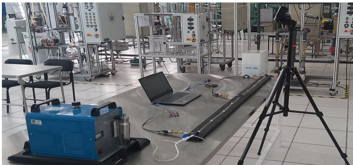
Figura 5.41: Arreglo experimental pruebas de deflagración
