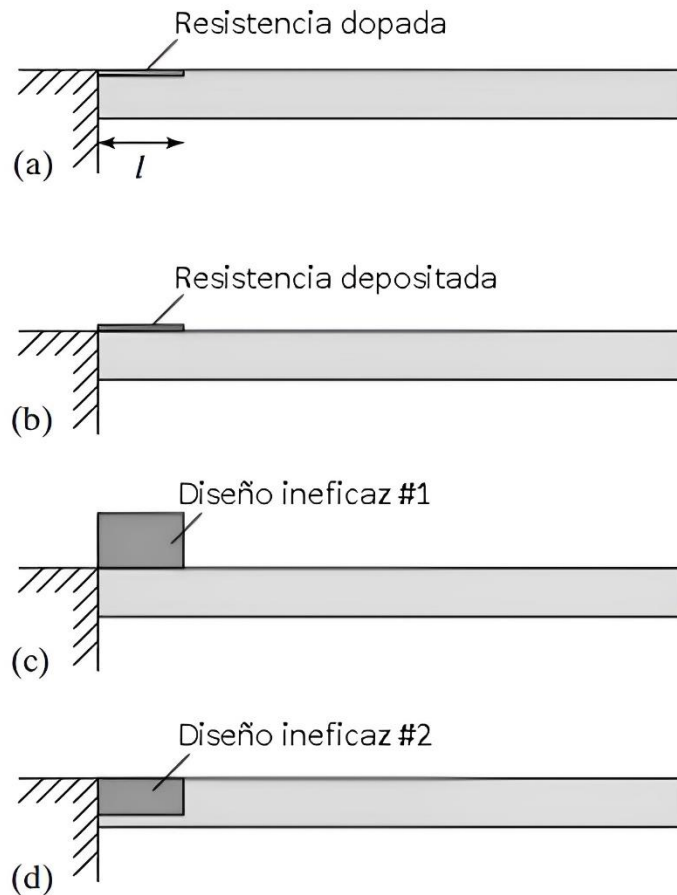
Figura 6. Diseños de cantilevers con piezorresistores
