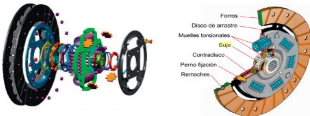
Ilustración 4. Constitución de disco de embrague
