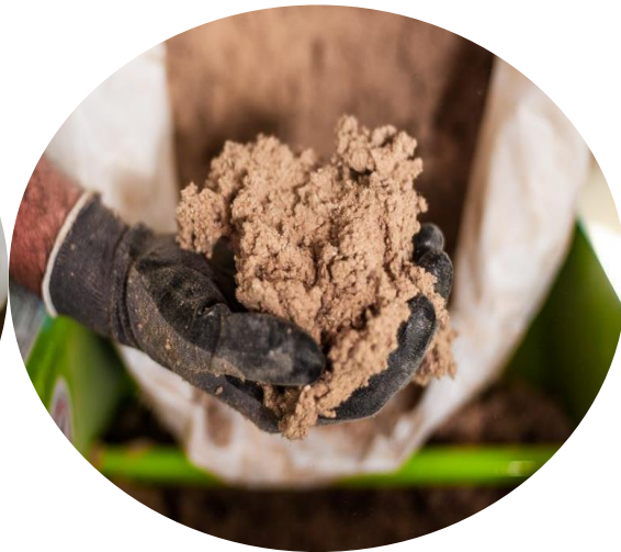
Imagen 8: La celulosa está hecha de fibras de papel y cartón estabilizadas. Una vez que se ha usado ese papel o caja, puede reciclarse para hacer aislamiento de celulosa. Imagen obtenida de: https://celulosa.pro/consumidores/que-es-celulosa/
