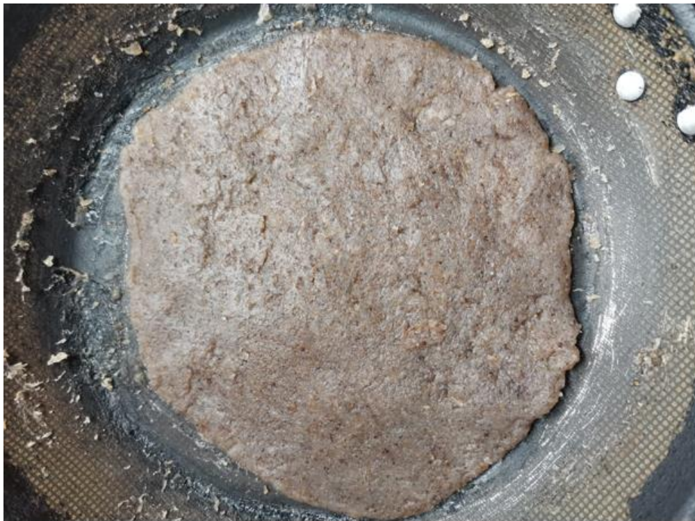
Fotografía 10: Se observa como queda la biopelícula después de ser moldeada, este es el penúltimo proceso antes de ser sometida al secado.
