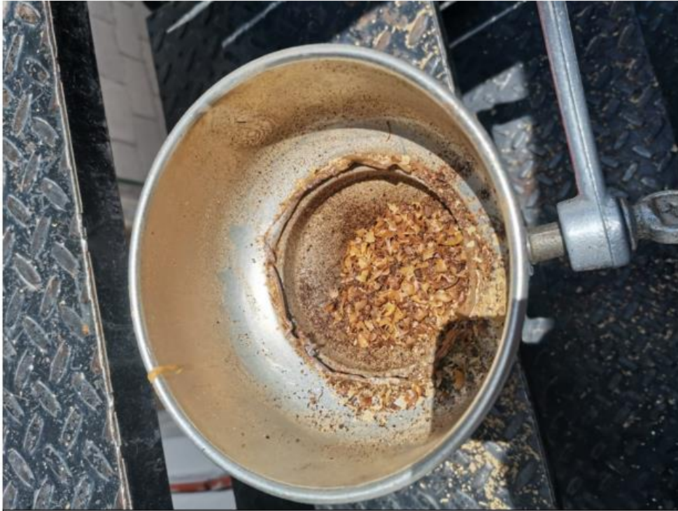
Fotografía 4: Se observa el proceso de la molienda con un molino manual.
