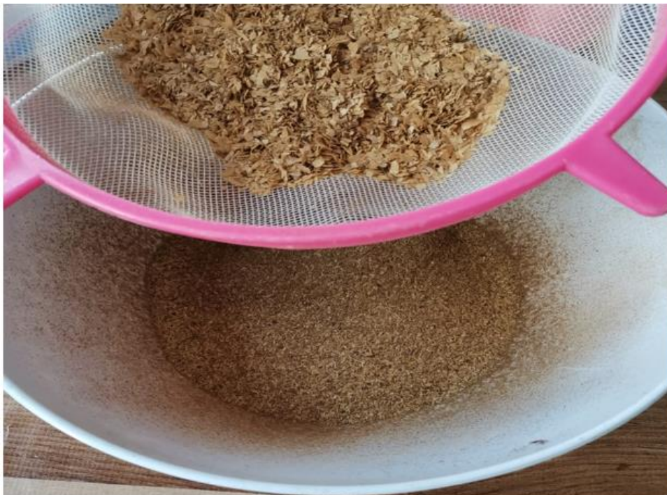
Fotografía 5: En esta fotografía se observa el proceso de tamizado el cual se realizo con un colador de cocina.
