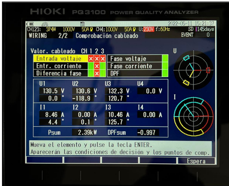
Figura 2.6: Error en la conexión del analizador [Captura propia]
