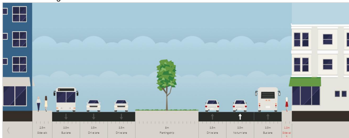
Figura 3.6. Sección de Carretera Federal Méx 136 México – Texcoco
