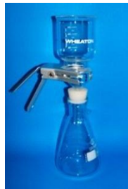
Figura 11 Equipo de filtración a vacío
