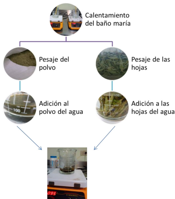
Figura 10 Esquema de la extracción del edulcorante de Stevia
