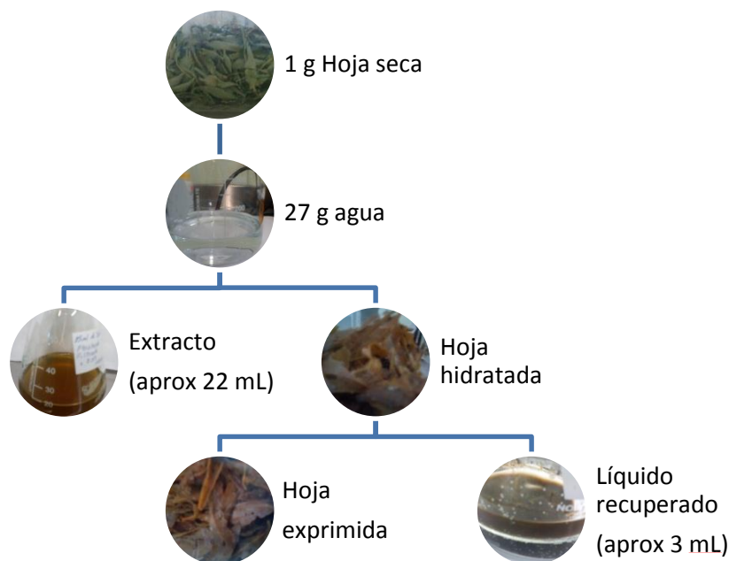
Figura 67 Esquema de la recuperación de extracto mediante prensado
