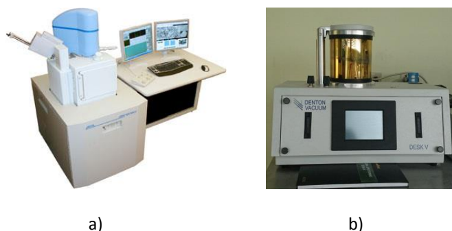
Figura 8 Equipo empleado en la caracterización: a) Microscopio electrónico de barrido marca JEOL modelo JSM-6610LV b) Evaporador marca Denton Vacuum modelo DESK V
