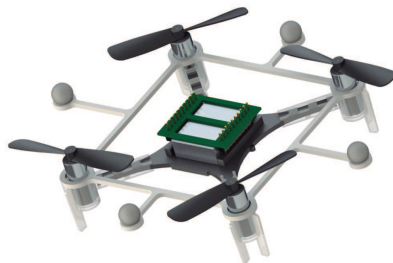
Figura 5.5. Configuración de marcadores en el VANT.
