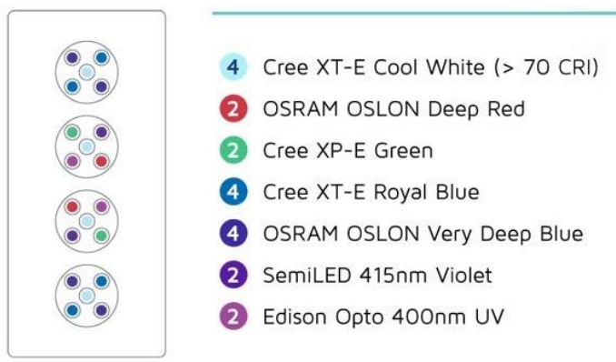
Figura 3.3. Arreglo de LEDs de la lámpara AI HYDRA. Los LEDs están dispuestos en 4 grupos de 5 diferente tipos de LED y sus valores de iluminación pueden determinarse independientemente. Son 7 tipos diferentes de LEDs nombrados (por sus siglas en inglés) : CW, Blanco; V, violeta; DR, rojo; G, verde; DB, azul oscuro; RY, azul; UV, ultravioleta.
