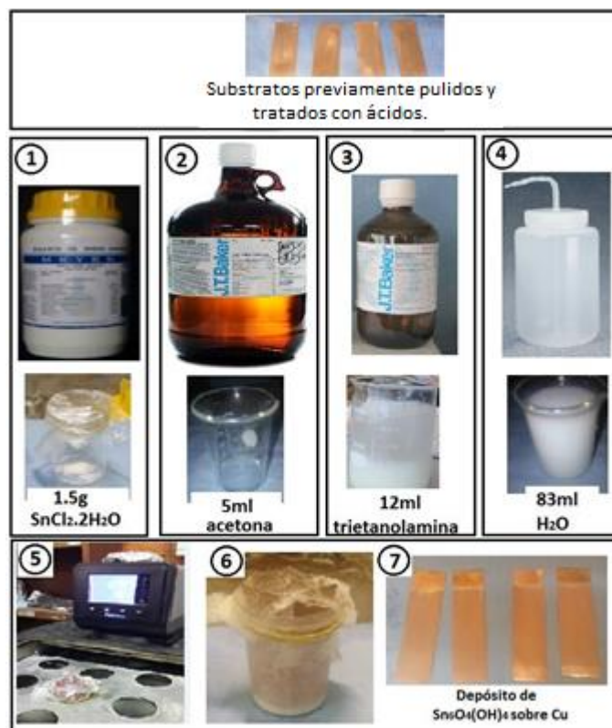
Figura 41 Secuencia para el depósito de \text{Sn}_6\text{O}_4(\text{OH})_4 sobre sustratos de cobre.
