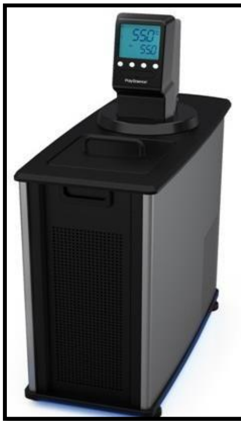
Figura 40 Equipo de baño químico utilizado para el depósito de películas de SnS.
