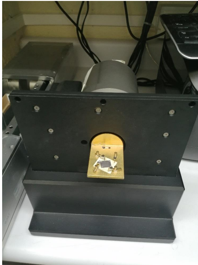
Figura 31 Equipo para la caracterización Hall-Van der Pauw.
