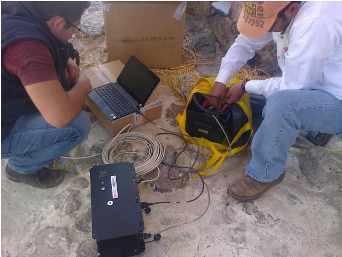
Fig. 82. Punto P-01 Medición de vibración ambiental en el centro de la base del cuerpo 3 de la Torre Campanario
