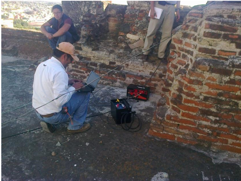
Fig. 91. Punto P-10 Medición de vibración ambiental en la Azotea y sobre la esquina de la Fachada y el Muro Lateral Sur
