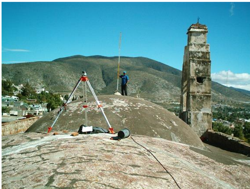
Fig. 11. Levantamiento de altimetría en la azotea
