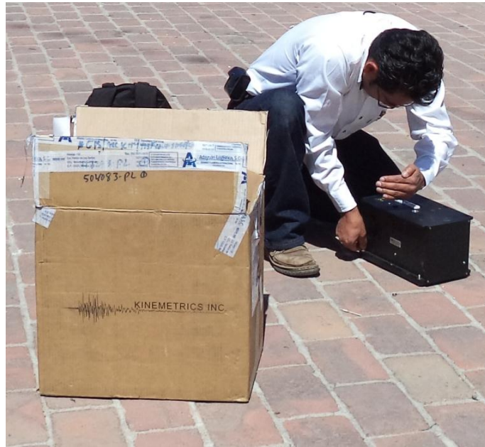
Fig. 93. Punto P-12 Medición de vibración ambiental en la Base de la Torre
