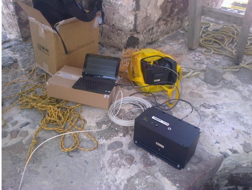
Fig. 83. Punto P-02 Medición de vibración ambiental en el centro de la base del cuerpo 2 de la Torre Campanario
