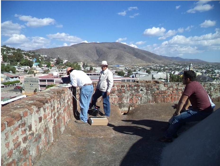
Fig. 89. Punto P-08 Medición de vibración ambiental en la azotea y sobre la esquina del Ábside Norte y el Ábside Oriente
