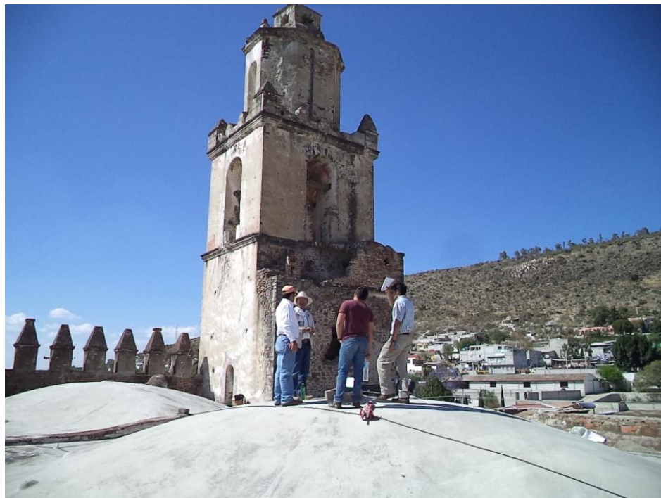
Fig. 86. Punto P-05 Medición de vibración ambiental sobre la Bóveda 3 del Recinto
