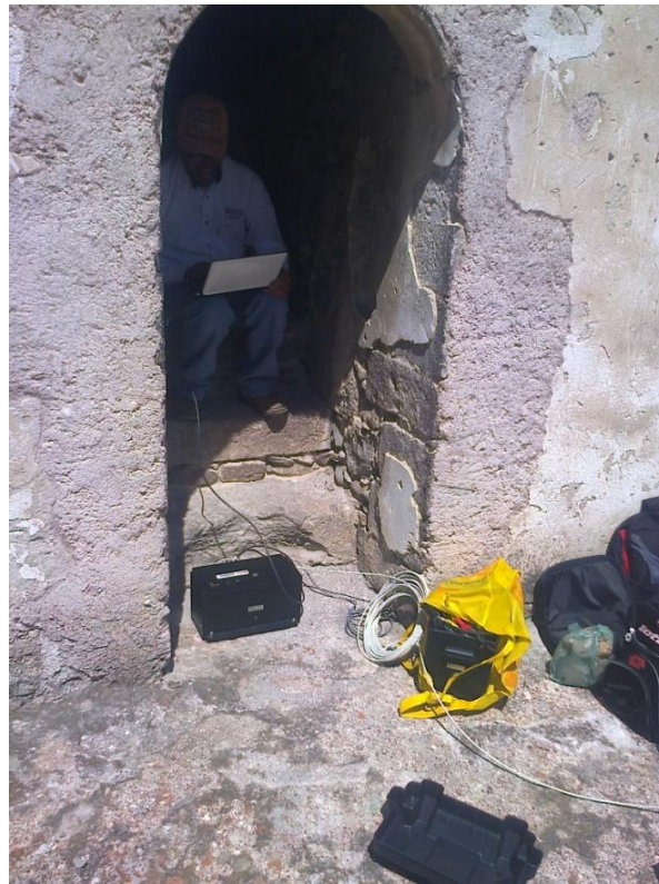
Fig. 84. Punto P-03 Medición de vibración ambiental en la base del cuerpo 1 de la Torre Campanario y sobre el muro lateral norte
