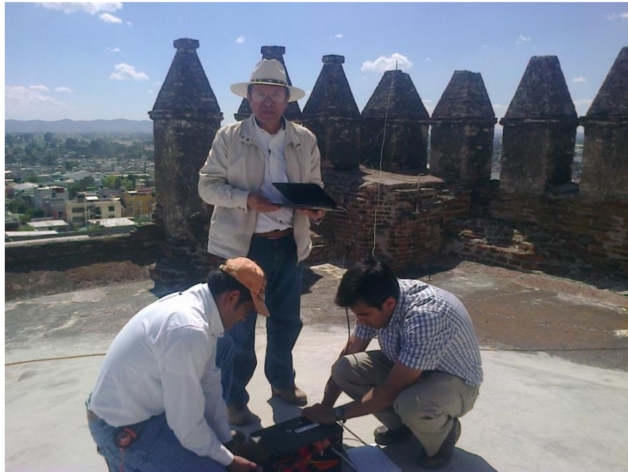
Fig. 85. Punto P-04 Medición de vibración ambiental sobre la Bóveda 4 del Recinto
