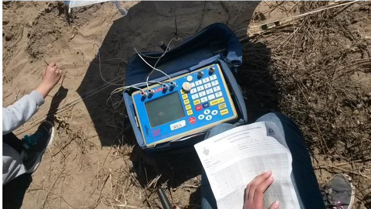
Figura 14: Saris conectado mediante cables a los electrodos AB y MN.
