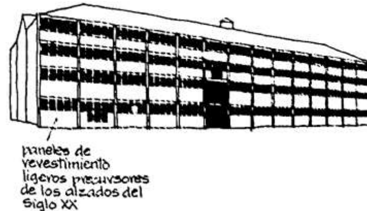
Ilustración 36. Greene, Almacén de barcos en los muelles de Sheerness (1858); Fue uno de los primeros edificios con estructura de hierro de varias plantas. Fuente: (Risebero, 1991, pág. 179)
